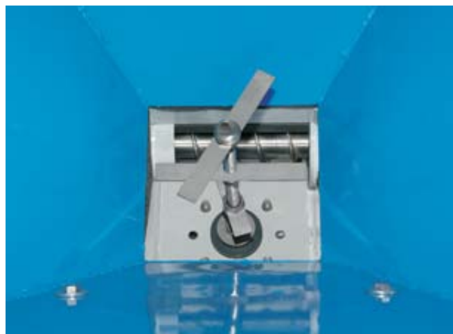
Mexedor mecânico de depósito
