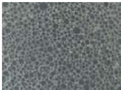
Secção cortada de amostra de B.C. Técnico (HC 250). Fotografia com lente de 5 aumentos.
