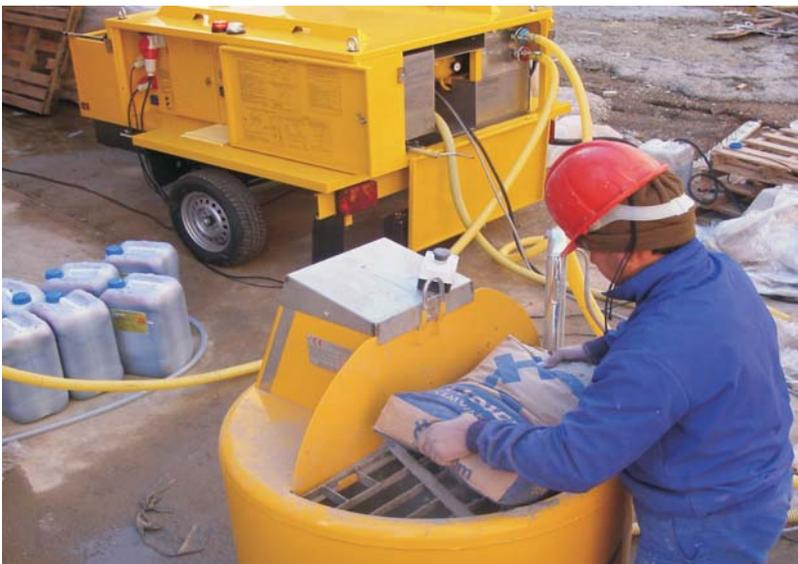
Máquina autónoma. Em obra apenas é necessário água, cimento, aditivo químico e energia eléctrica. Fácil de manejar através de 2 operários. Quando se bombeia até ao caudal máximo e/ou a dificuldade da obra assim o requeira será necessário mais pessoal.
