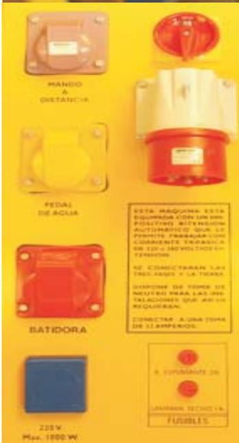
Panel esquerdo com tomadas de ligação e fusíveis. Não há a possibilidade de erro graças às diferentes cores de tomadas e cavilhas.
