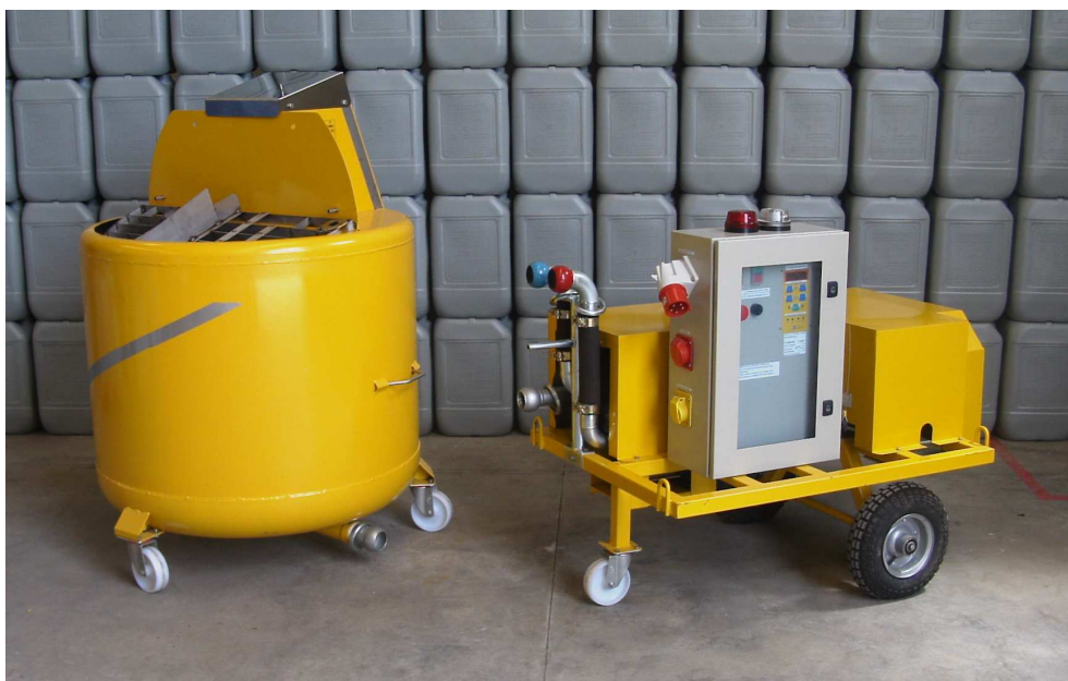
Macchina con pompa di dosaggio dell'acqua.
