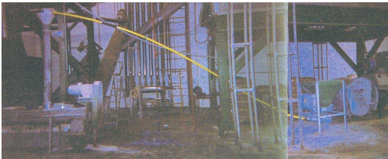
Trasporto del prodotto dosato con il CT-16/360 fino a 18 metri di lunghezza e 6 metri di altezza tramite attrezzature facoltativa.
