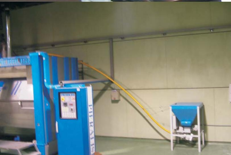
**Dosatore installato in fabbrica di elaborazione dell'olio d'oliva. Il punto di aggiunta del prodotto in questo caso si trova nel primo corpo di gramolazione.**
