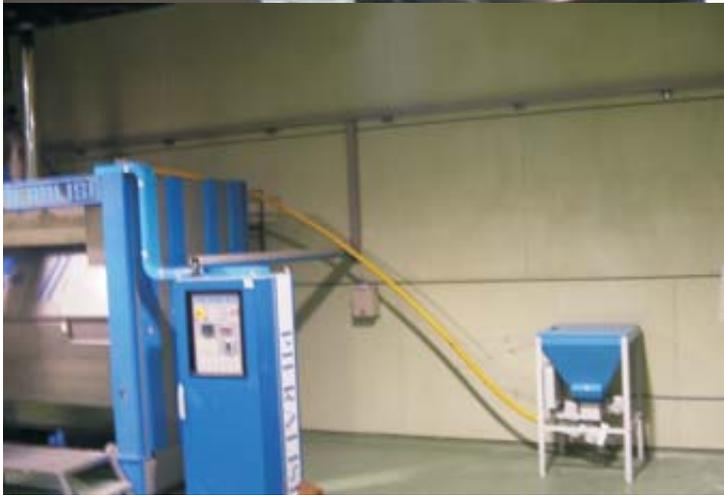
Dosificador instalado en fábrica de elaboración de aceite de oliva. El punto de adición del producto se realiza en este caso en el primer cuerpo de batido.
