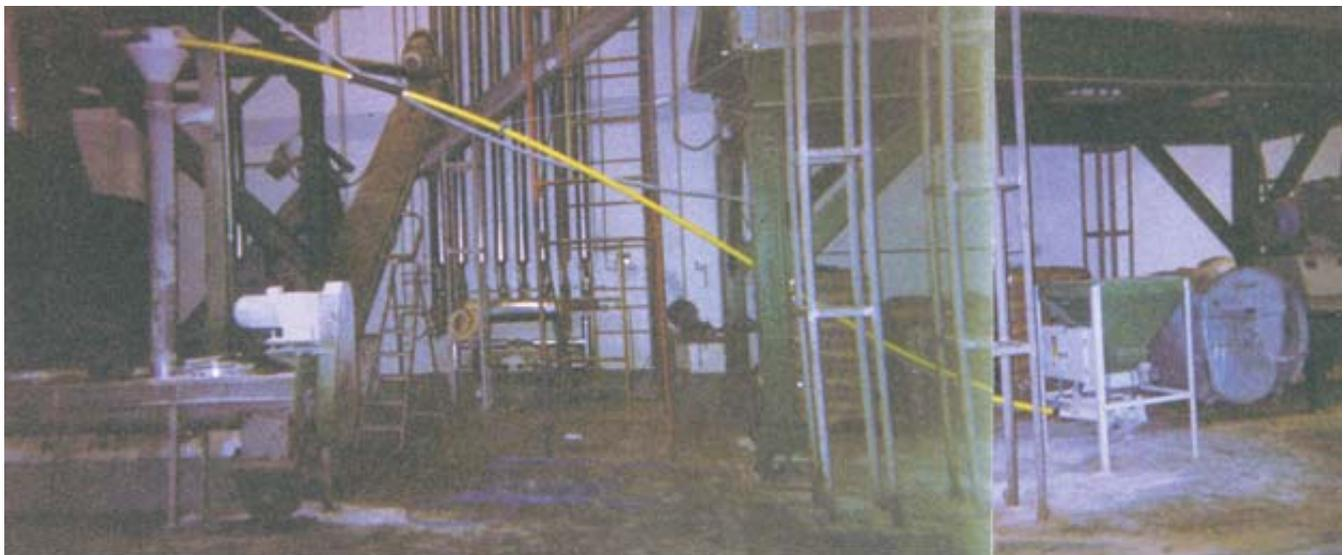
Transporte del producto dosificado con el CT-16/360 hasta los 18 metros de longitud y 6 metros de altura mediante equipamiento opcional.
