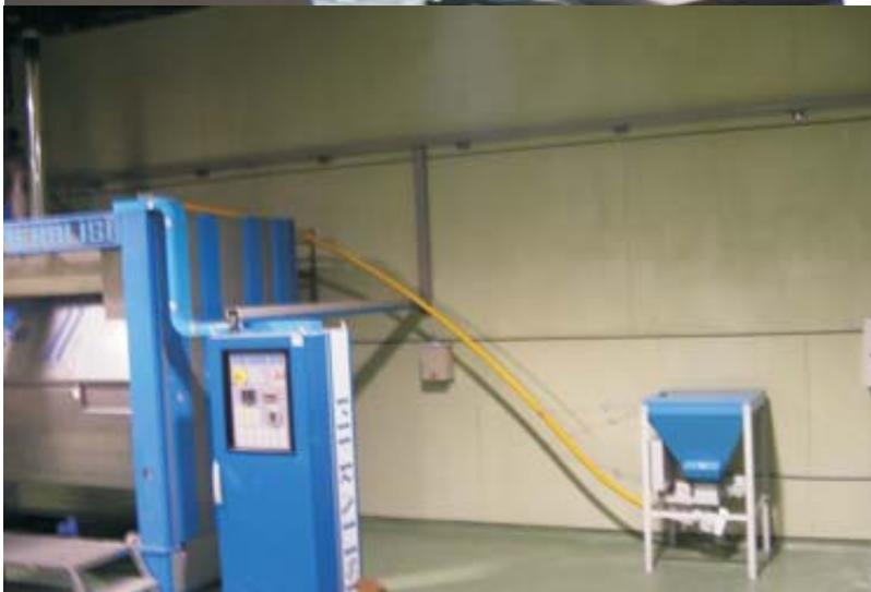
El dosificador volumétrico CT-16/360 es una máquina capaz de desarrollar 2 trabajos: La dosificación de cualquier producto en polvo y el transporte del mismo hasta la máquina receptora.
